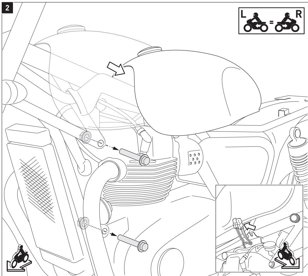
**⚠️ HINWEIS:** Gezeigt ist die Montage des linken Sturzbügels. Die Montage des rechten Sturzbügels erfolgt analog zur linken Seite.
