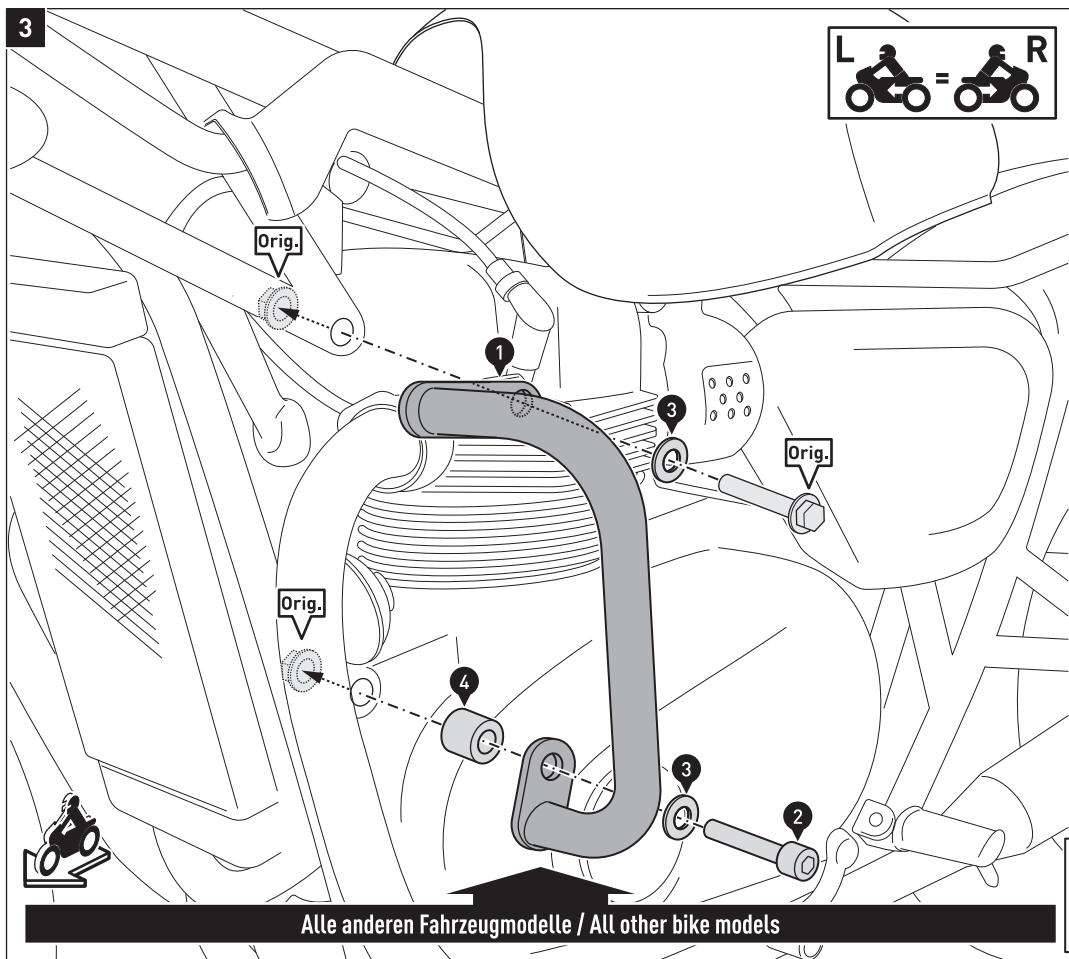
Verschrauben Sie den Sturzbügel (1) mit der original Schraube (Orig.) und Schraube (2) sowie den original Muttern (Orig.) am Fahrzeug.
