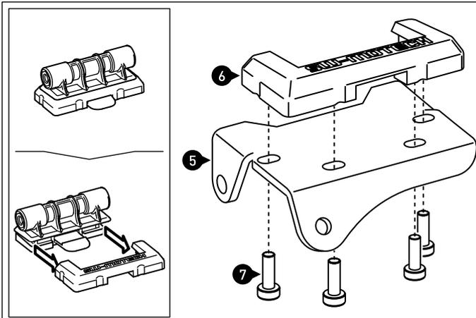
**2** **ACHTUNG! Bitte beachten Sie, dass Halterahmen und Einschubrahmen zusammengesteckt ausgeliefert werden.** Verschrauben Sie den Halterahmen (6) mit dem Anbaublech (5), wie in der Zeichnung gezeigt. Ziehen Sie die Schrauben vorsichtig, wie in der Stückliste vorgegeben, an.
