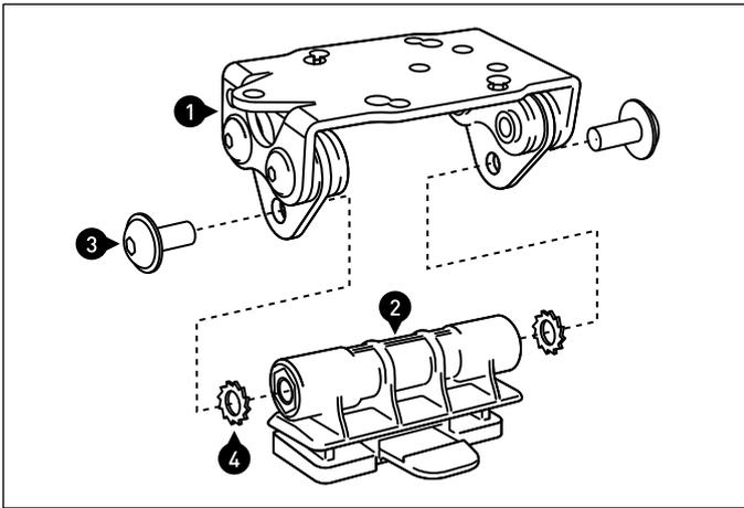
**1** Verschrauben Sie das gedämpfte Oberteil (1) mit dem Einschubrahmen (2), wie in der Zeichnung gezeigt. Ziehen Sie die Schrauben noch nicht an.
