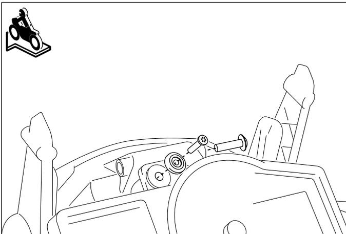
**4** Entfernen Sie die gezeigten originalen Schrauben.
