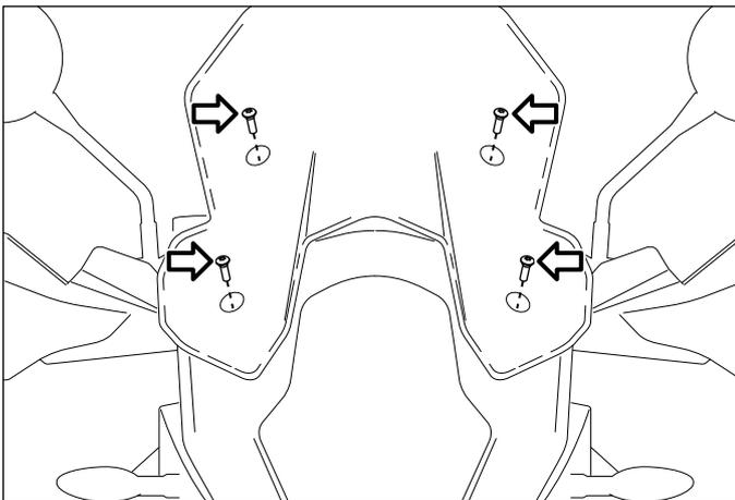
**3** Entfernen Sie die markierten Schrauben; entfernen Sie anschließend das Windschild.
